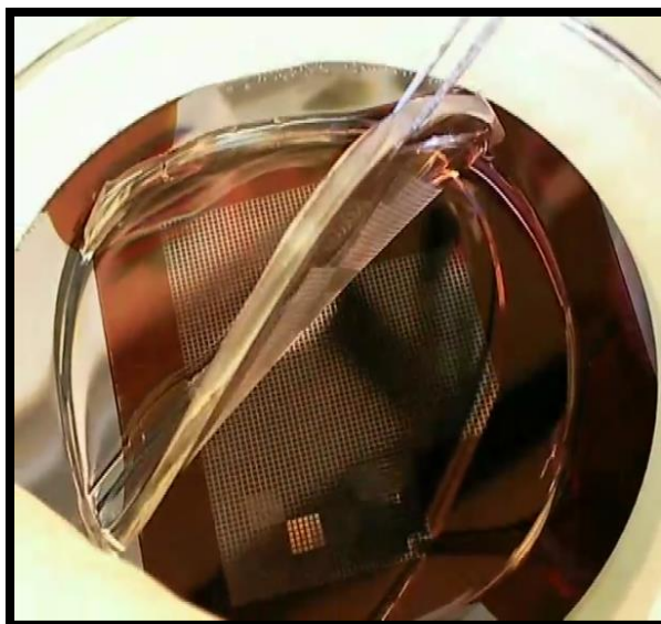
Figure 11. Décollement de la couche PDMS [32].
